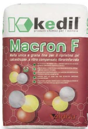
Malta rasante per ripristino del calcestruzzo antiritiro, fibrorinforzata composta da leganti cementizi, additivi chimici ed inerti. La granulometria selezionata con punta massima di 0,5 millimetri, conferisce elevata resistenza meccanica con finitura civile. Con **MACRON F** si possono eseguire spessori di 4 centimetri in un'unica mano.
