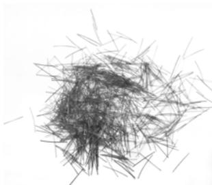
Fibra sintetica per manufatti cementizi. Ideale per evitare la formazione di crepe da ritiro durante la fase di indurimento. L'utilizzo delle fibre migliora la qualità della superficie, riducendone le porosità, aumentandone la resistenza all'abrasione e agli urti.
