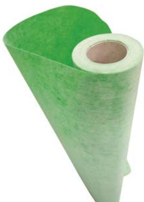
Membrana impermeabile, posizionata sotto lo strato di piastrelle, impermeabilizza e protegge il pavimento dalle rotture del massetto e dalle migrazioni dell'umidità. Questo grazie ai due strati esterni di tessuto in propilene con uno strato interno di polietilene.
