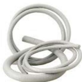
Filtene è un materiale di riempimento per giunti in polietilene espanso a celle chiuse, comprimibile, resiliente, chimicamente inerte, antiaderente nei confronti di tutti i sigillanti.
