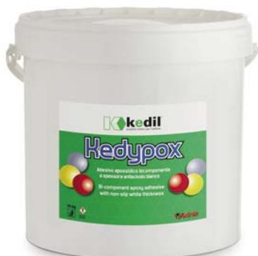
Collante epossidico bicomponente ad altissima adesione, ideale su tutti i supporti, inodore, facilmente spatolabile. **KEDYPOX** è ideale per la posa in piscina o vasche in completa immersione, ottimo in situazioni estreme di incollaggio. Scivolamento verticale nullo, per la posa di grandi formati su sottofondi non perfettamente planari, spessore consentito del collante 15 millimetri.
