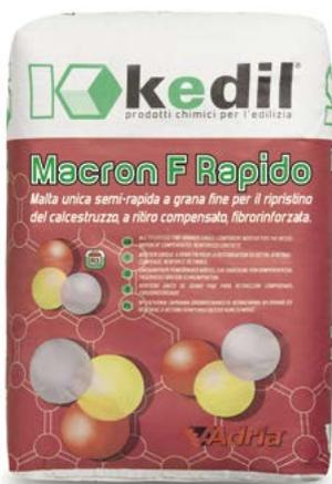
Malta a presa rapida per ripristino del calcestruzzo antiritiro, fibrorinforzata composta da leganti cementizi, additivi chimici ed inerti. La granulometria selezionata con punta massima di 0,5 millimetri, conferisce elevata resistenza meccanica con finitura civile. Con **MACRON F RAPIDO** si possono eseguire spessori di 4 cm in un'unica mano. Il prodotto è in classe R4 come descritto nella En 1504-3.
