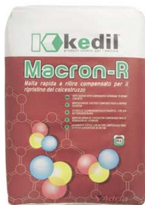
Malta a presa rapida per il ripristino del calcestruzzo. Premiscelata antiritiro, tixotropica e fibrorinforzata, composta da leganti cementizi, additivi chimici ed inerti. La granulometria selezionata le conferisce caratteristiche di elevata resistenza meccanica unite alla possibilità di effettuare riporti autosostenenti ad alto spessore, senza ricorrere ad opere di cassetatura della struttura ammalorata. Il prodotto è in classe R4 come descritto nella En 1504-3.
