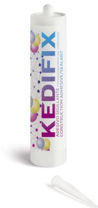
KEDIFIX è un adesivo sigillante MS polimero, monocomponente ad alto modulo per l'edilizia. Tixotropico, reticola tramite l'umidità atmosferica garantendo alte prestazioni di elasticità permanente, alta resistenza all'invecchiamento e agli agenti atmosferici. Privo di solventi ed isocianati. **KEDIFIX** utile per incollare su diversi supporti profili in alluminio o plastica, sigilla giunti e fessure a pavimento o parete. Verniciabile dopo indurimento.
